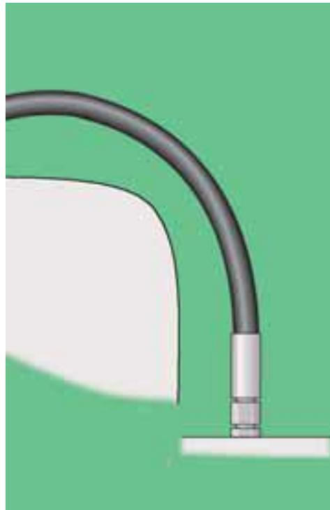
**注意事项：**通常情况下，管子应避免与其他物品的表面相接触，在有些情况下，如果无法避免，应选用超耐磨表面的软管，或给软管配上防护套。
